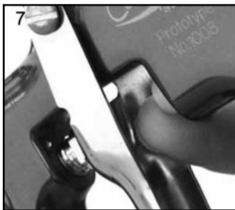
7. Haga salir la junta delantera de la válvula de aire empujando con el dedo.
