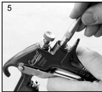
5. Usando la herramienta de mantenimiento SPN-7, enganche la muesca detrás del asiento de la válvula.
