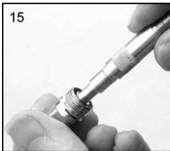
15. Coloque la junta en el alojamiento (10).
