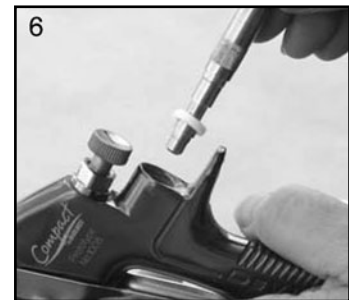
6. Retire el asiento de la válvula.
