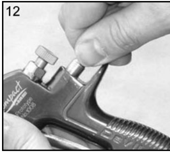
12. Coloque el asiento de válvula en el cuerpo de la pistola.
