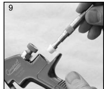
9. Instale una junta delantera nueva en la herramienta de mantenimiento.
